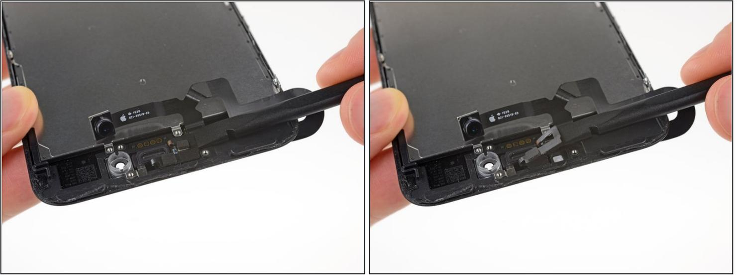
⚠ 这一步，传感器非常的脆弱。要增加无损拆卸的几率，使用 iOpener 或者吹风机加热屏幕。或者，滴两滴酒精，使之浸透之后，再撬动。
