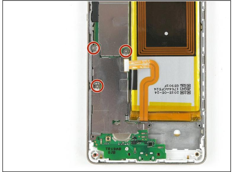
**i** 为了在拆卸电池时保护你的主板，你可以重新安装屏蔽板，以便更安全地进行撬动。
