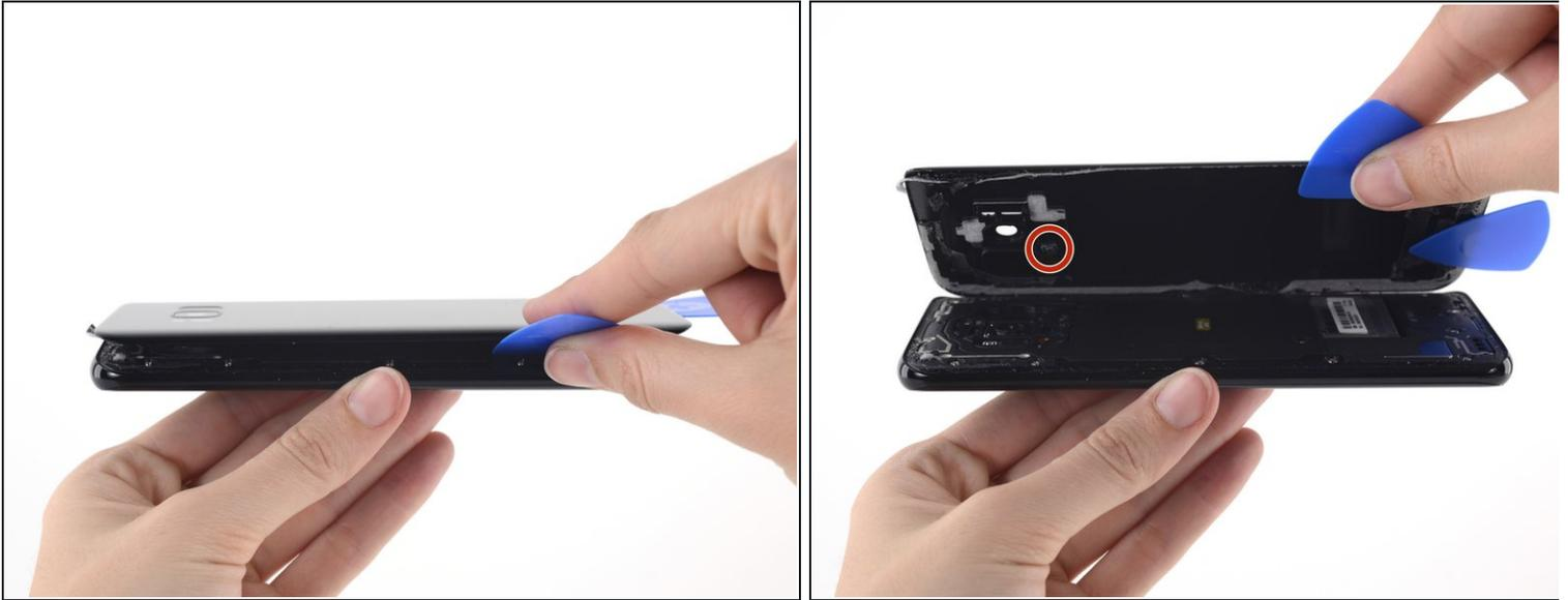
① 指纹传感器线缆与手机在后玻璃面板靠近主摄像头的位置连接。这个线缆十分的短，在移除玻璃面板的时候也要断开。
