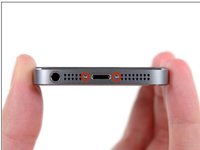
**⚠** 在继续操作之前，请将iPhone电池的电量降至25%以下。如果不小心刺破带电的锂离子电池会发生火灾和/或爆炸。
