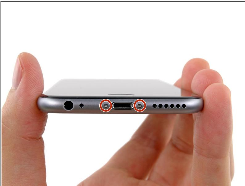
⚠️ 在拆卸 iPhone 之前，请将电池放电至 25% 以下。如果意外刺破，带电的锂离子电池可能会着火和/或爆炸。
