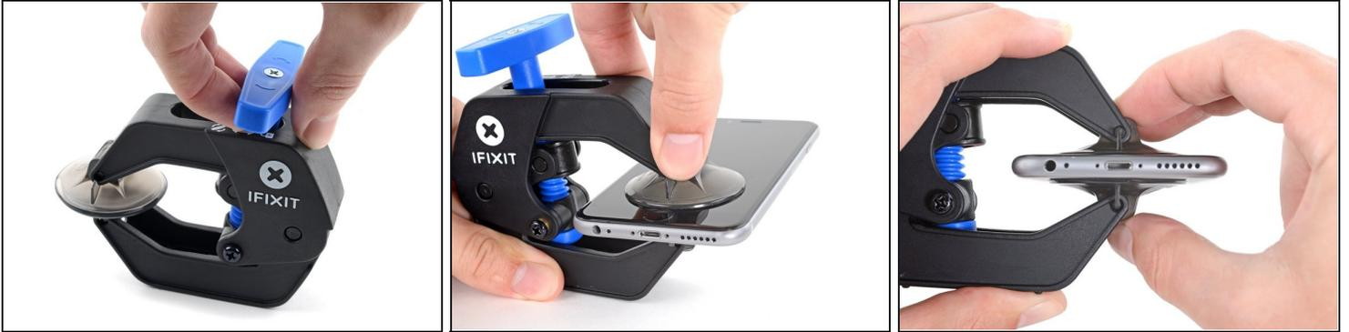
① 接下来的三个步骤会用到反向钳，我们设计的一个让分离屏幕更方便的工具。如果你没有反向钳，跳过下面的3个步骤来寻找其他的方法。
