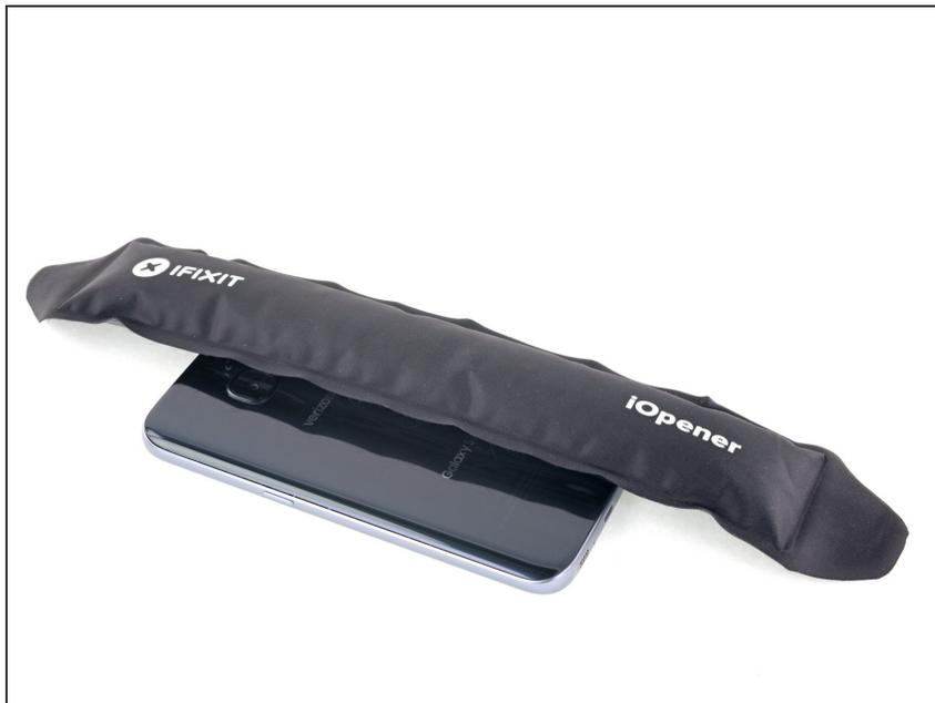
ⓘ 拆开你的手机将会损坏手机的防水胶。在你继续之前，准备好用于更换的粘合剂，或者如果你重新组装时不更换粘合剂的话，请防止任何液体接触你的手机。
