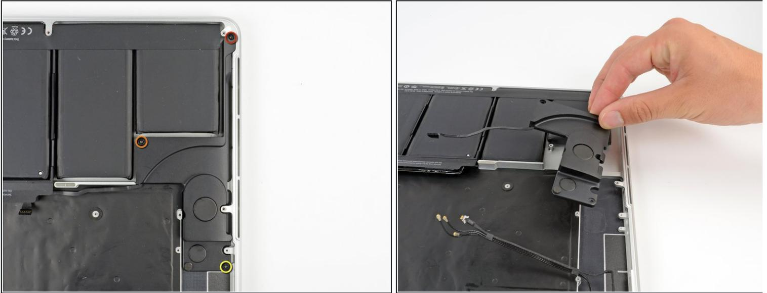
● 移除下列将右侧扬声器固定在顶壳上的三颗螺丝。
