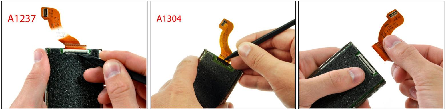
**⚠** 两个不同版本的MacBook Air 有着不同的连接头。操作失误可能让机器损坏您的硬盘！断开连接时请务必小心。ZIF连接器是脆弱的。
