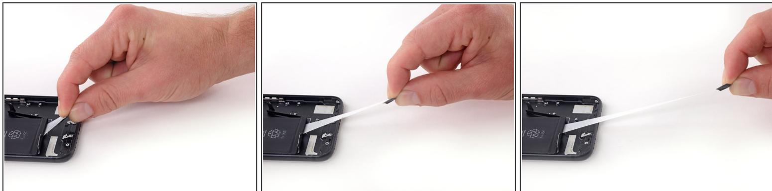
**⚠** 在操作的时候尽量保持胶条平直不要弄皱了，起皱的胶条容易黏在一起并且容易拉断在向外拉的时候。
