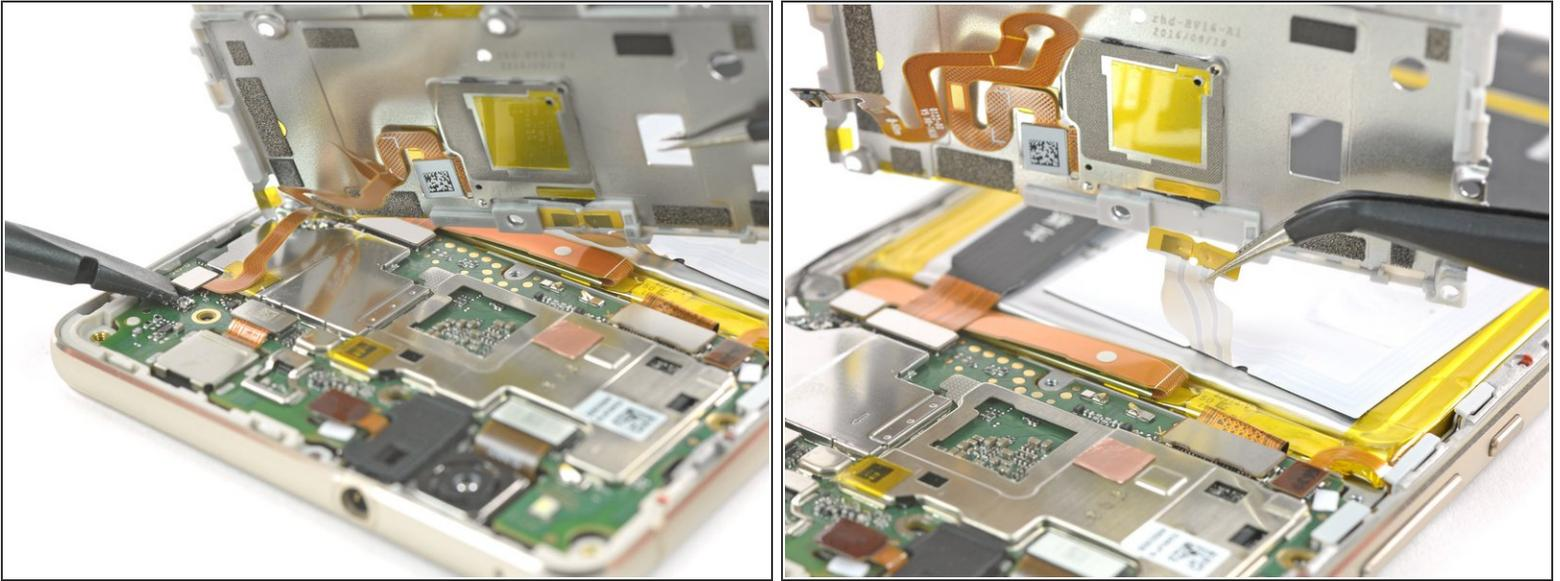
**⚠** 不要拆下屏蔽板，它是通过连接器和电缆连接的。
