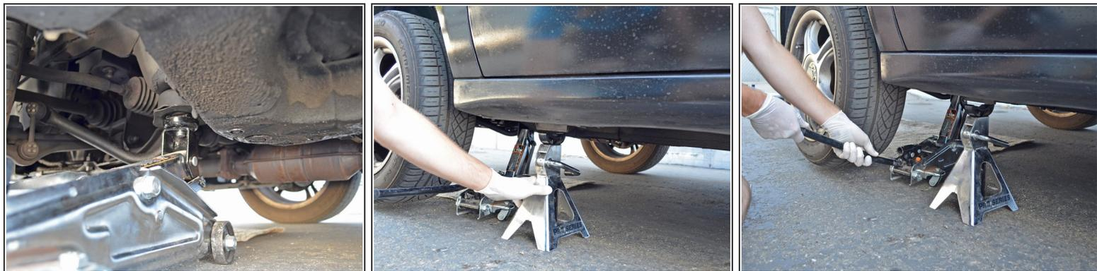
**i** 由于雅阁千斤顶顶起位置不够大，无法将千斤顶以及千斤顶支架同时放入，你必须将千斤顶放置在前副架上来抬起汽车。
