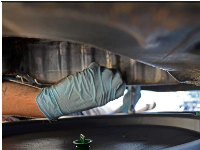
**⚠** 在操作机油时永远佩戴保护手套以及保护眼镜。如果车在操作前运行过一段时间，那么引擎和传动系统会十分的热。准备抹布或毛巾擦拭机油。
