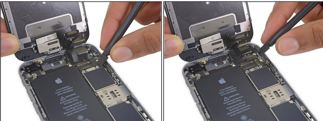
⚠ 在此步骤中断开或重新连接排线之前, 请确保已断开电池的连接。
