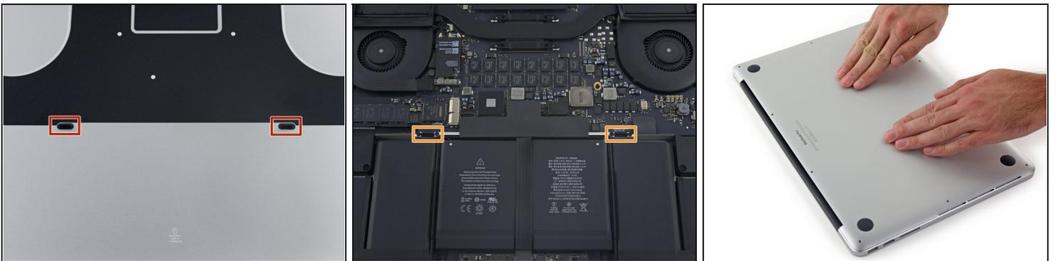
① 底部盖板上有两个塑料夹子（红色），在上面的箱子里卡扣（橙色）可以装进塑料夹子。
