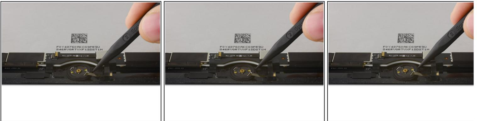
**⚠ 在接下来几步中，您将要从您的iPad前面板中分离Home键垫圈。这个垫圈十分细小，也特别容易被撕裂。如果垫圈不能够从前面板上分离，请使用iOpener来重新加热。**
