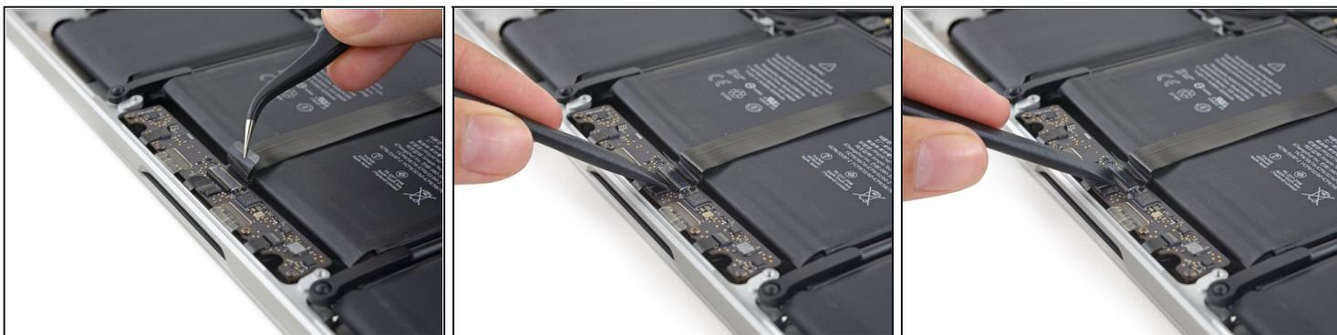
① 如果有必要的话，剥下所有粘在触摸板线缆上的胶带。
