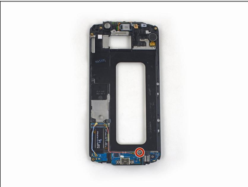
● 卸下一个将子板固定到显示框架的3.0mm Phillips #00螺丝
