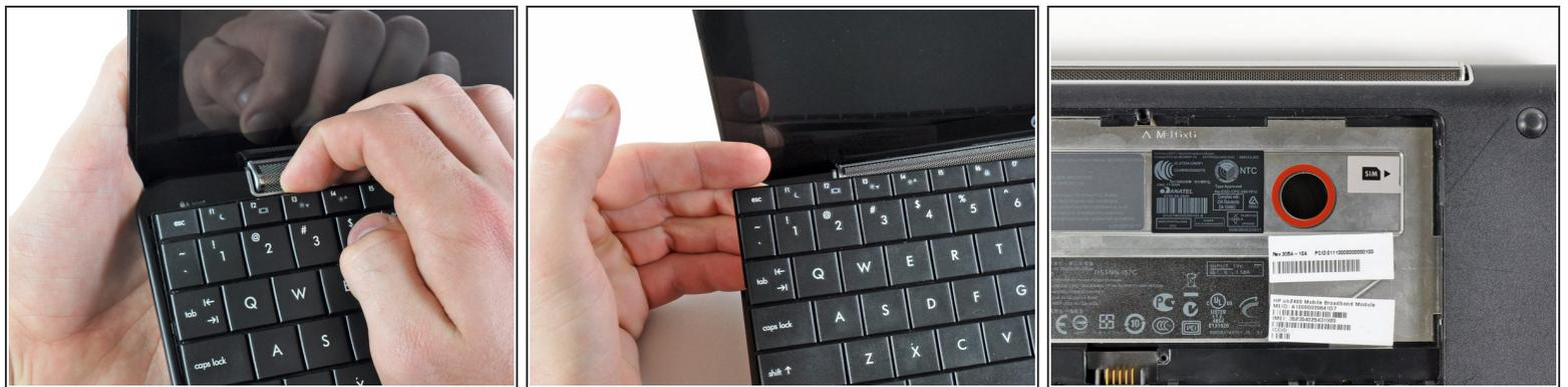
**i** 为了方便拆卸键盘，建议用一只手将键盘向外推，位于Mini 1000背面的开口（第三幅图中突出显示的位置）。
