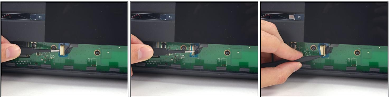
① 前按钮电缆有着一个独特的ZIF连接器，请注意按照以下步骤断开连接。
