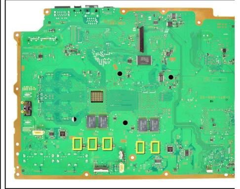
● 在所示位置将新的散热垫贴到主板上：
