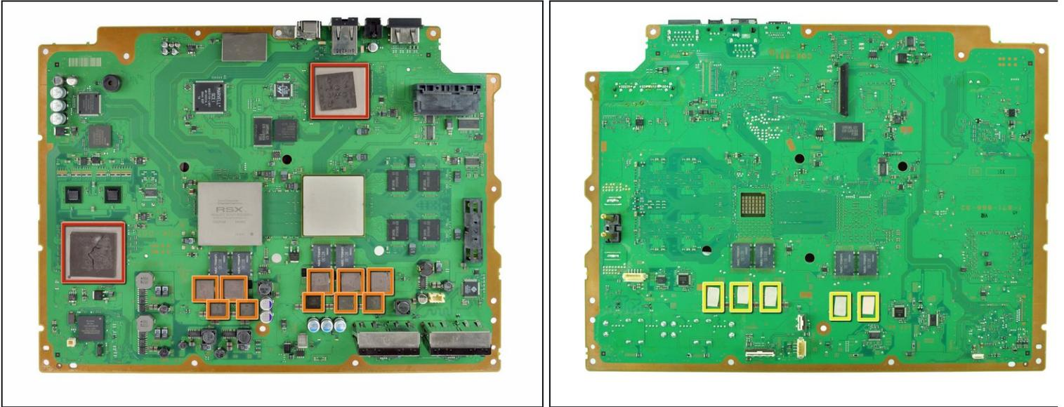
● 使用手指或撬棍的平头，按照指示移除逻辑电路板上的旧散热垫。
