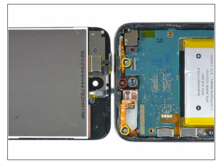
● 拆下主板板顶边附近的三个螺丝:
