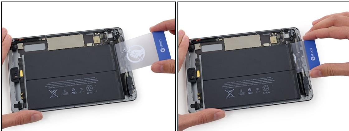
**⚠** 在以下過程中，您將在iPad的電池和後蓋之間滑動薄塑料卡，以分離將電池固定到位的膠粘劑。小心保持卡片盡可能平坦，以避免彎曲電池，這可能會損壞電池，並釋放出危險的化學物質。
