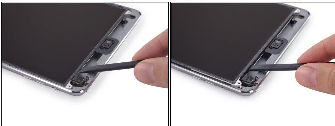
ⓘ 切勿现在尝试将LCD面板完全分离开来，它仍与iPad通过位于Home键附近的几条线缆相连。只可以从前置摄像头处提起。
