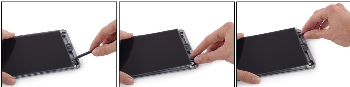
① 液晶显示屏由温和的粘合剂固定，在将LCD面板从屏蔽板上翻转之前，请分离粘合剂。
