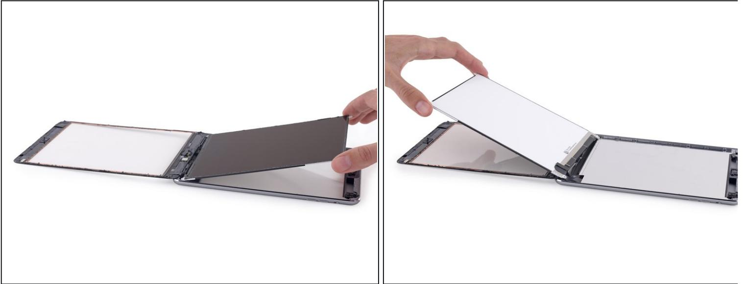
**⚠ 切勿尝试将LCD面板完全分离开来，它仍与iPad通过位于Home键附近的几条线缆相连。只可以从前置摄像头处提起。**
