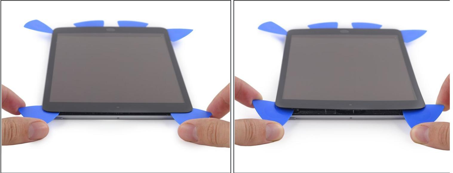
**⚠️ 小心操作这一步，花点时间保证粘合剂是热和软的，同时确保您的撬片已经分离开了该分离的粘合剂。不要怕返工和重新加热。**
