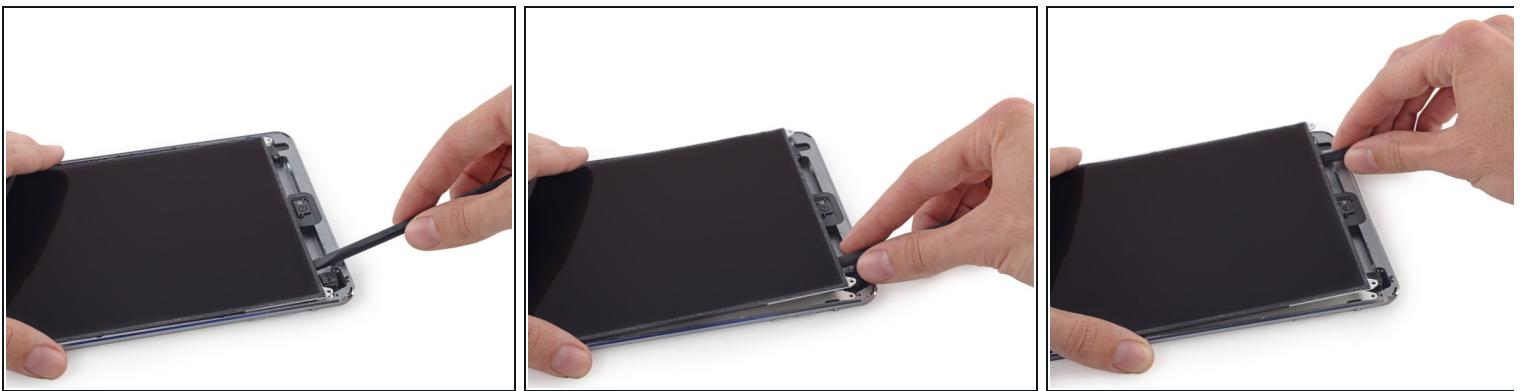
① 液晶显示屏由温和的粘合剂固定，在将LCD面板从屏蔽板上翻转之前，请分离粘合剂。
