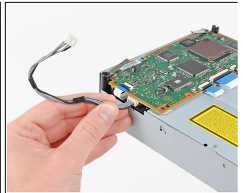
**⚠ 用你的指甲在蓝光带状电缆插座上翻转固定襟翼。**
