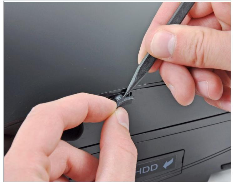
① 使用一个撬棒的尖端从PS3的侧面去除黑色橡胶螺丝盖。
