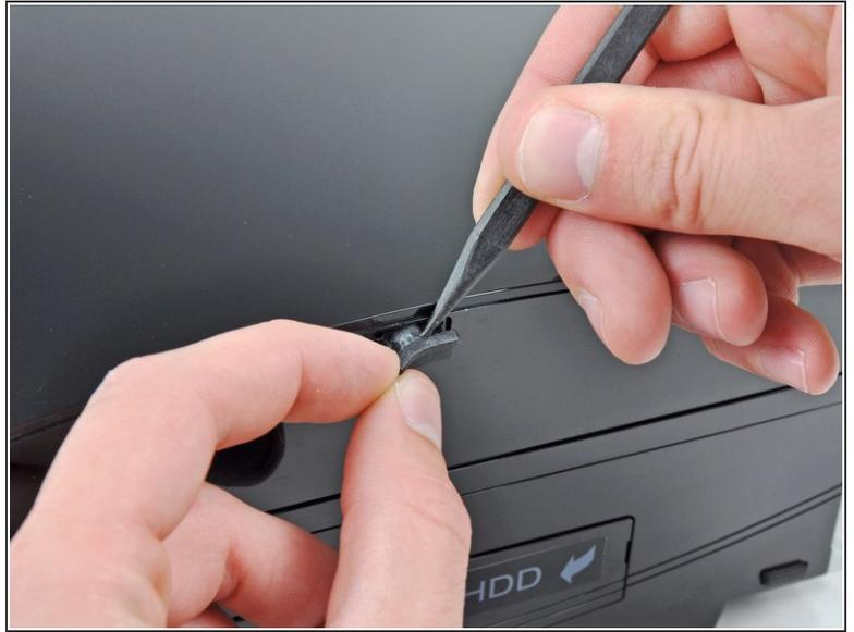
**i** 使用一个撬棒的尖端从PS3的侧面去除黑色橡胶螺丝盖。
