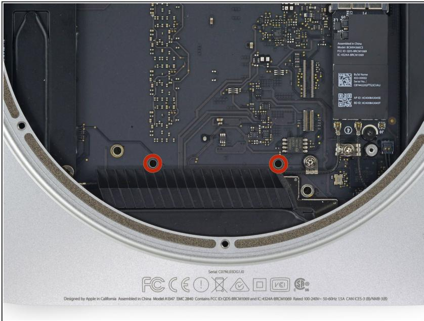
**⚠** 为了移除主板，Mac Mini主板移除工具的两个圆形的头子必须插入图上红色圆圈标注的口里。如果插到任何一个其他主板上的口里，有可能会损坏主板。
