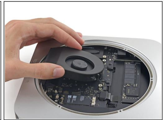
**i** 风扇连接器卡在风扇的角落，拔掉后永远也不能装回去了。
