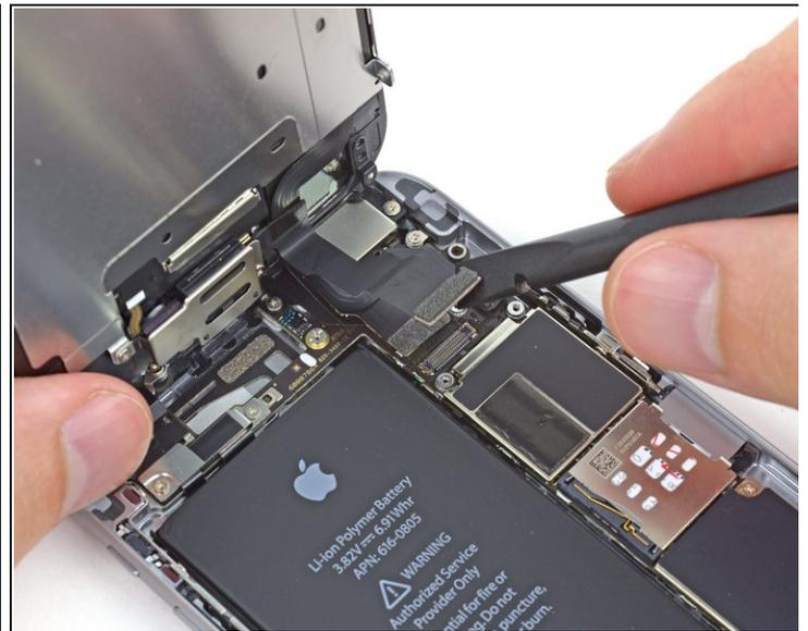
⚠ En los próximos cuatro pasos, ten cuidado de **solamente** hacer palanca en los conectores de cable y no en los enchufes en la placa lógica.
