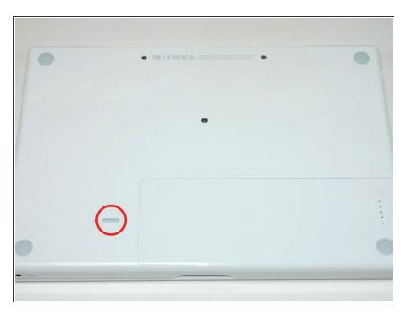
Drehe die Verschlussschraube des Akkus mit einer Münze oder einem Spudger um 90° im Uhrzeigersinn.
