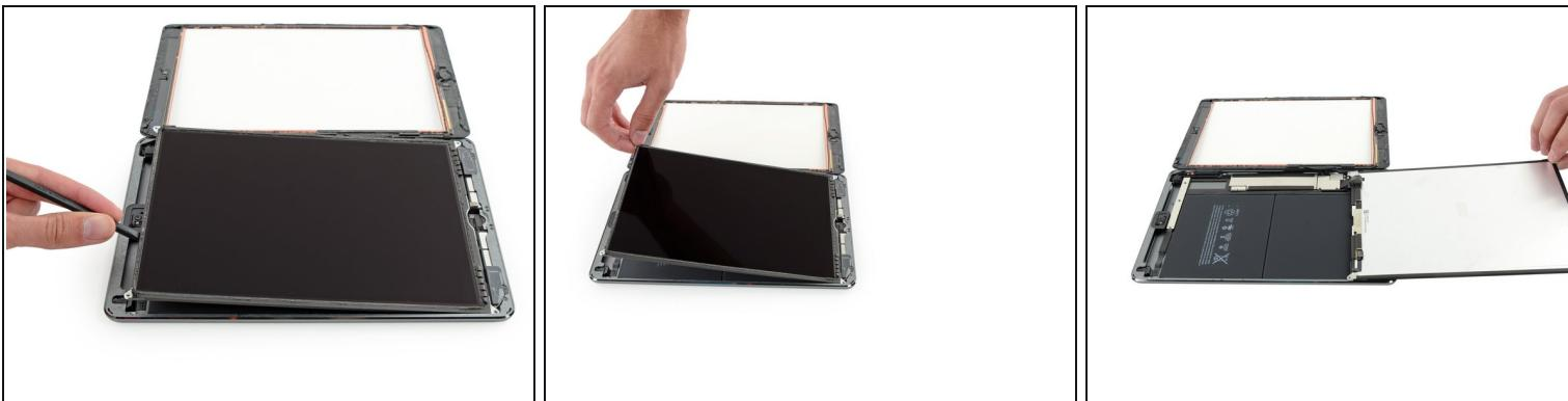
**⚠ 因为LCD屏幕任然在Home键附近有许多排线与iPad Air主体相连，切勿尝试完全的将LCD屏移开。仅可从前置摄像头尾端处抬起屏幕。**
