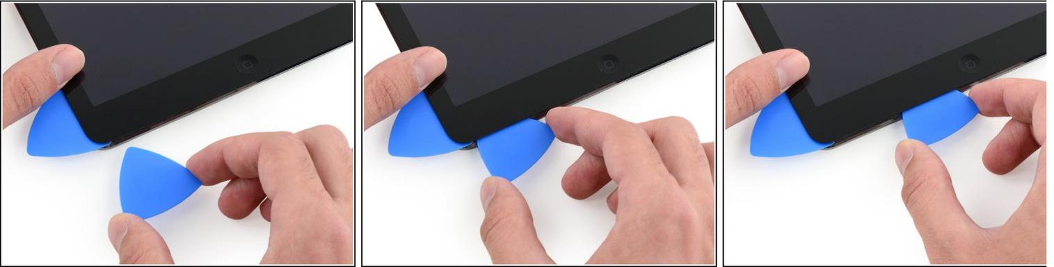
❶ 将原撬片放置在原位，以防粘合剂重新粘合。
