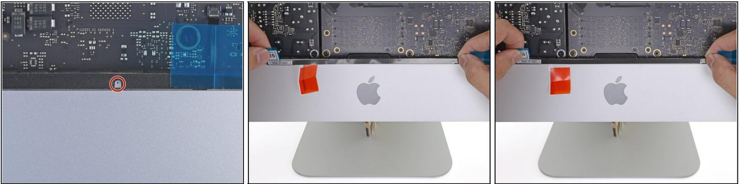
① 麦克风孔为[中心孔](#)，两侧有两个较大的孔。
