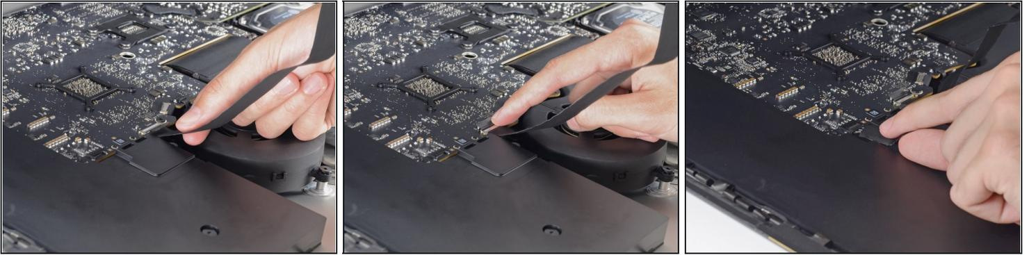
ⓘ 此时，最好测试一下你的修复工作，以确保你的 iMac 能正常工作，然后再将其重新封好。请按照以下三个步骤暂时重新连接显示屏电缆，并在从胶条上撕下保护膜之前启动 iMac。
