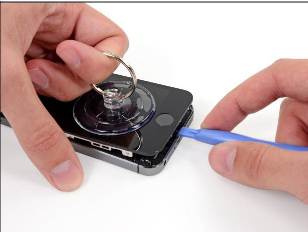
⚠ 屏幕通过卡扣固定在机身，并且有几条带状电线连接着屏幕和机身。你的目标是把卡扣脱离，然后打开足够的空间用来分离电线就可以了。所以在操作时你需要非常缓慢，谨慎地避免损坏电线。
