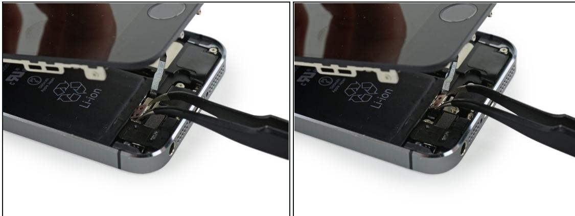
**👉 重组的时候，你会需要重新安装 Touch ID 电线支架。这个支架的顶部需要从电池和Touch ID线缆接头之间的空间滑入，底部必须被连接器锁死。**
