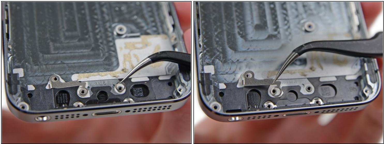
① 在移除lighting排线时，金属支架与垫圈容易丢失。
