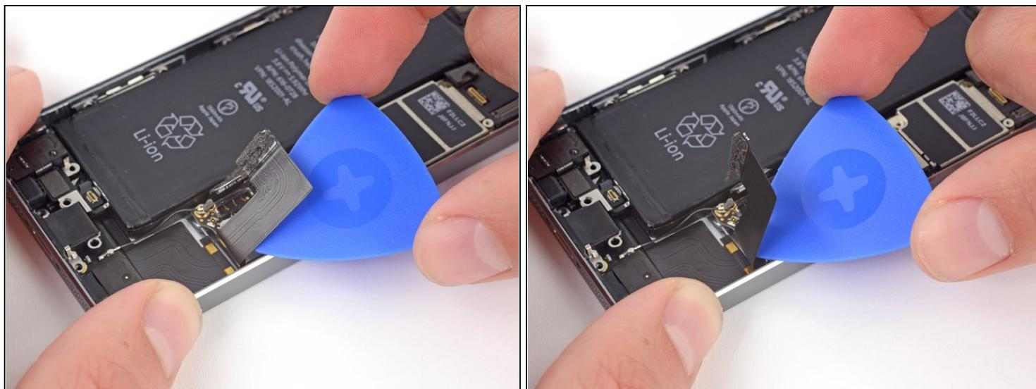
ⓘ lightning 数据连接线使用粘合剂与逻辑板和后壳相连。
