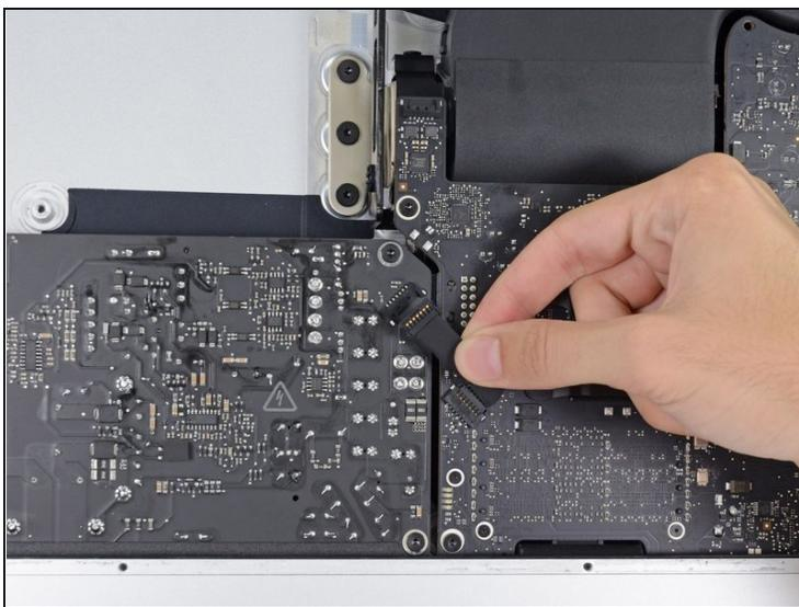
**⚠ 当在电源上工作时，要非常小心，不要触摸电容器引线或电源背面的任何暴露的焊点。只能从主板的边缘处理。**
