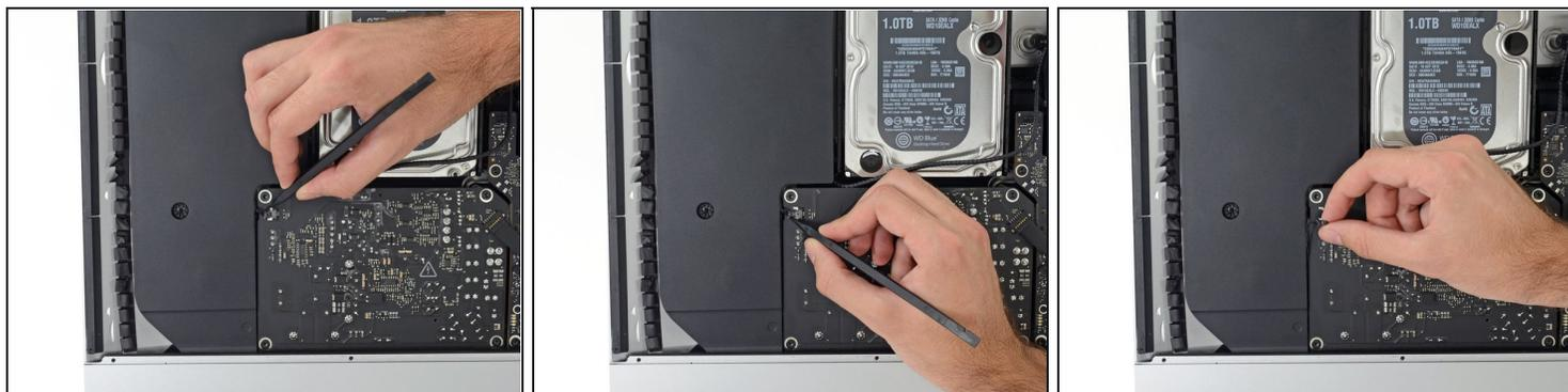
⚠ 小心 切勿触碰任何电源背板上的金属焊点。电容内可能还有余电，对您造成伤害。
