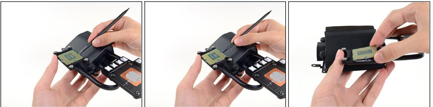
**ⓘ CPU 很可能被用导热膏粘在散热器上。**
