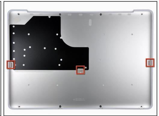
**⚠** 下壳由橡胶涂层的铝构成。在拆卸过程中不要过度弯曲铝壳，因为任何永久变形会导致重新组装后的公差问题。
