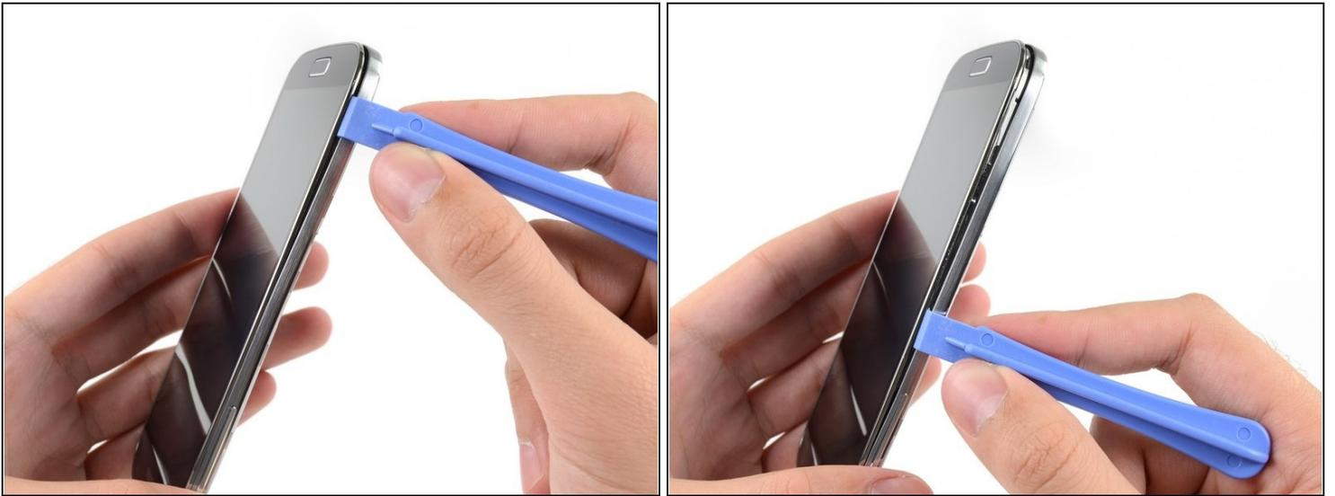
① 中框是由几个塑料卡子后面的中框镀铬挡板固定在显示组件上的。接下来的步骤将指导你分离中框与屏幕组件的连接。
