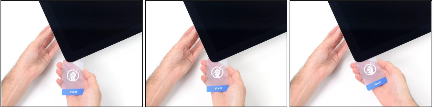
① 虽然打开工具可以切开大部分粘合剂，但显示屏仍会与外壳有轻微粘连。需要使用塑料卡来切开最后的粘合剂。
