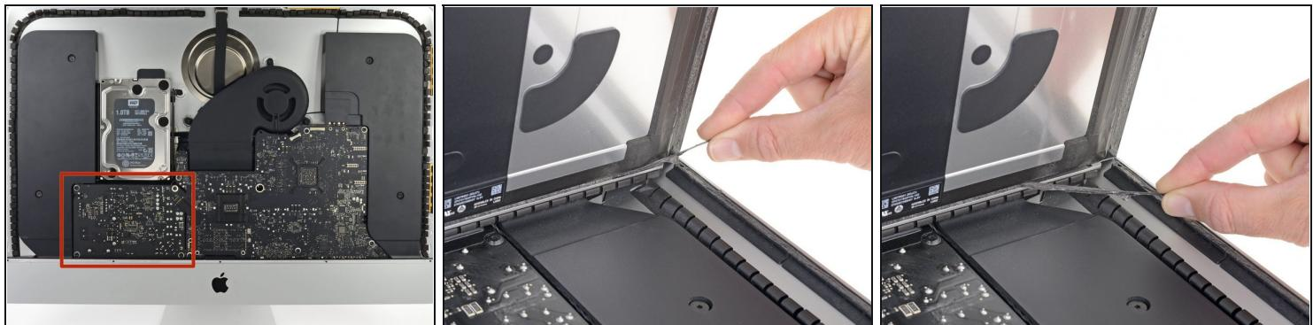
⚠ 要非常小心，不要触摸电容器引线或电源背面的任何暴露的焊点（红色框内）。
