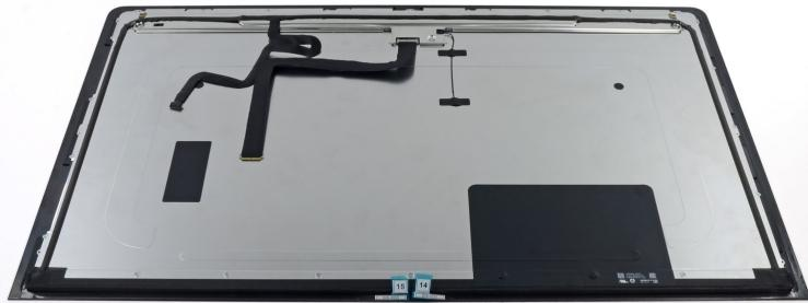
*(i)* 如果您需要替换显示器面板，您可能需要将额外的组件从旧面板转移到新面板上。比较新旧面板的背部。注意：所有的线缆，传感器和泡沫缓冲材料不随新面板提供。
