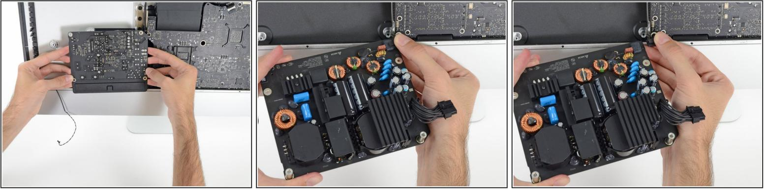
**⚠ 小心 切勿触摸电源上的任何电容、导线以及暴露的触点。 只可抓取电源的边缘部分。**
