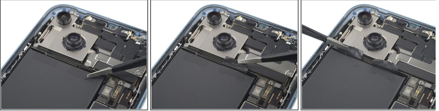
**⚠ 注意：**剥离胶条时请不要使用任何锋利的工具以免戳破电池。被刺破的电池可能会有危险的化学物质泄漏或起火。
