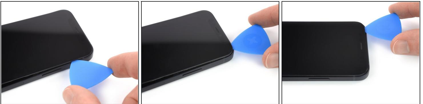
① 显示器的顶部边缘用胶水和夹子固定。
