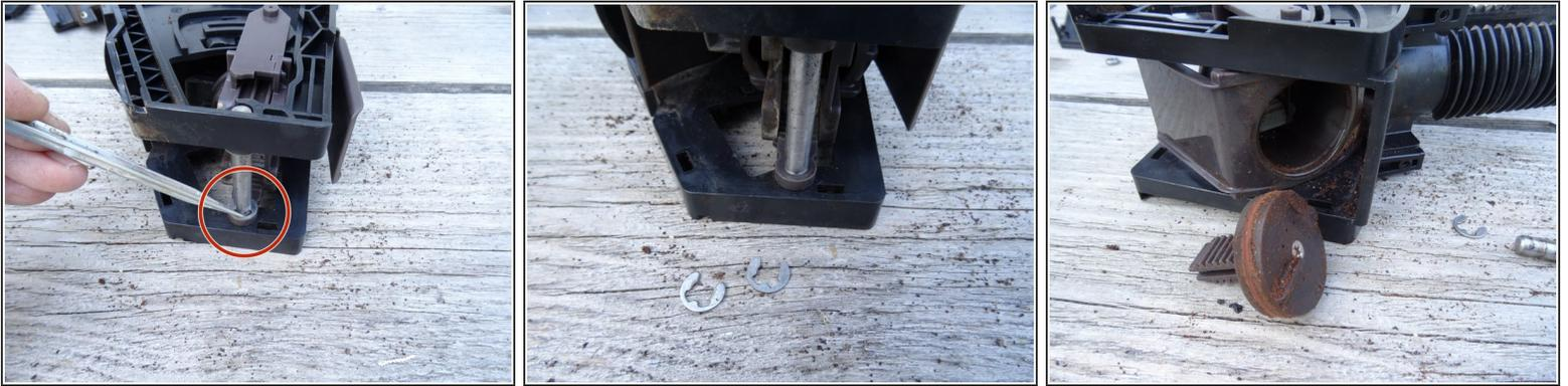
**i** Im folgenden Schritt wird der untere Kolben gelöst.
