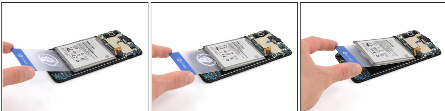
**⚠** 在此过程中，请尽量不要使电池变形。软壳锂离子电池可能会泄漏危险的化学物质，着火甚至损坏，甚至爆炸。请勿用力过大或用金属工具撬动电池。
