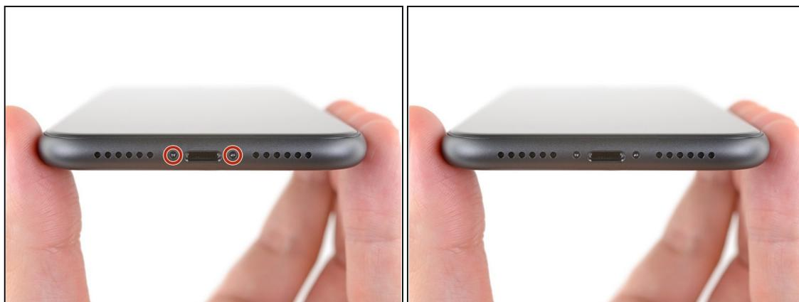
**⚠** 在开始之前，请将 iPhone 电池的电量降至25%以下。充电的锂离子电池如果意外被刺破可能会着火和/或爆炸。
