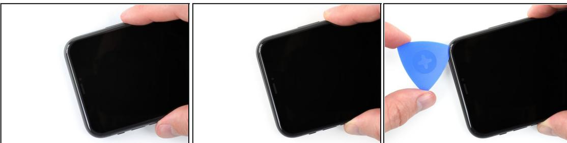
ⓘ 显示器的顶部边缘用胶水和夹子固定。
