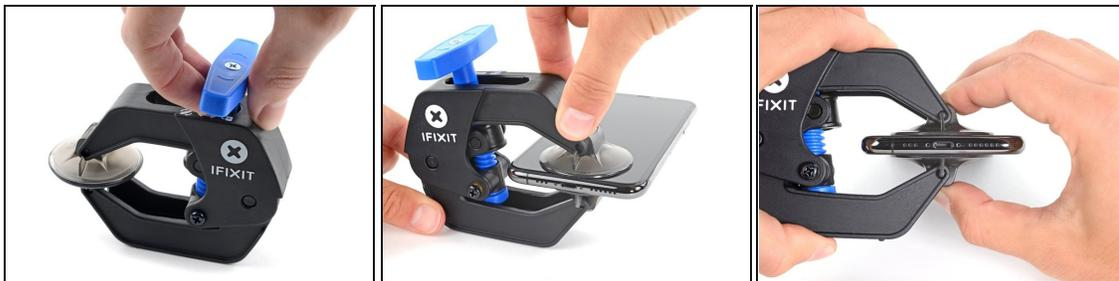
**i** 接下来的三个步骤演示了反向钳，这是我们为经常维修的人推荐的一种便捷工具。如果你不使用反向钳，请跳过接下来的3个步骤以观看另一种方法的指南。
