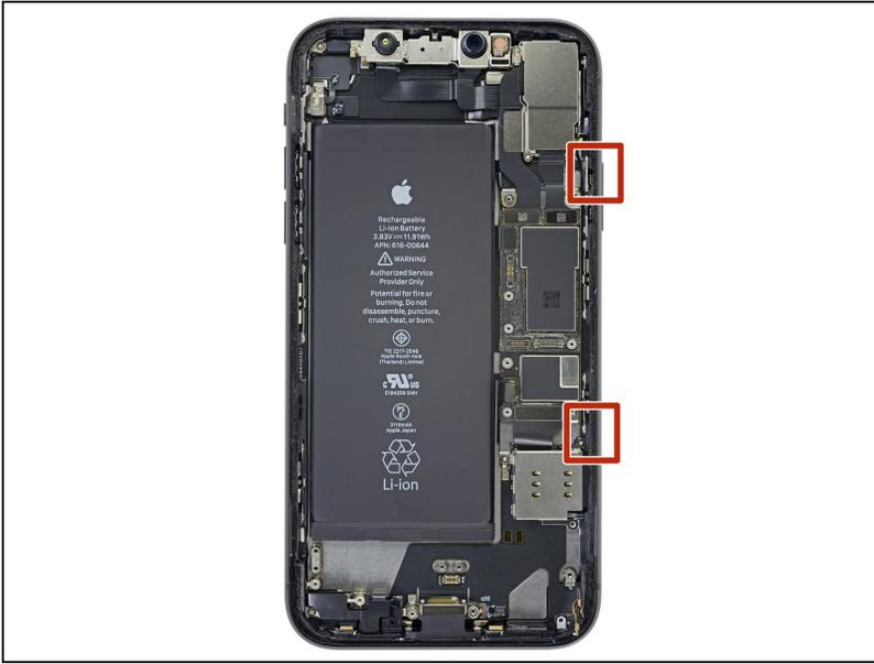
⚠️ 红圈标注的位置有非常脆弱的排线，请勿将三角撬片插入此处，否则将会损坏排线。
